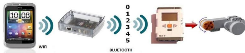
**Fig. 2.** Représentation du système d'envoi de commande entre un client (téléphone Android (a)) et l'actionneur du robot (d), via un système FoxBoard (b) connectée par Bluetooth à la brique intelligente (c).
